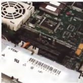
I circuiti di un'unità prodotto dalla TDK: la ventola è costruita in plastica, i componenti elettronici sono miniaturizzati, il sistema di raffreddamento è "passivo", il sistema di alimentazione è a 5 volt, il display è a colori. In alto a sinistra: il sistema di raffreddamento
